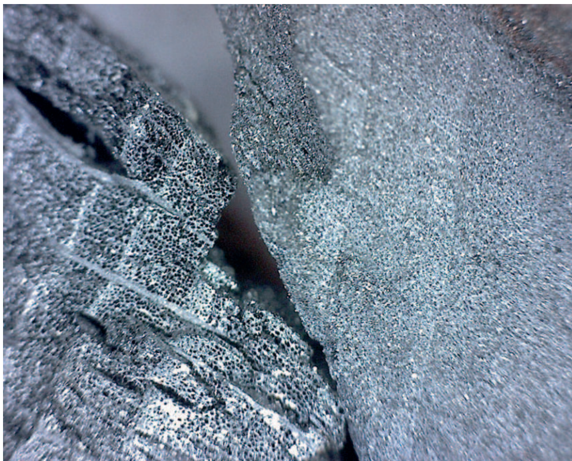
Ryc. 7. Obrazy mikroskopowe dwóch rodzajów węgla z próbki N8/2012 — przekroje poprzeczne (po prawej stronie próbka szerokosłoista z niewidocznymi promieniami drzewnymi, po lewej stronie próbka wąskosłoista z widocznymi promieniami drzewnymi)
